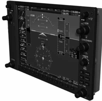
Figure 3-2. GDU 1040A Display
