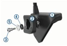
2 Con la llave Allen incluida, fija el soporte al transductor con el tornillo de resalto ③, la arandela de goma ④ y la arandela plana ⑤.
