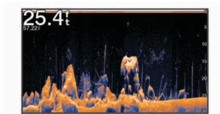
Traditionelle Geber senden einen konischen Kegel. Die Garmin ClearVü Echolottechnologie sendet einen Kegel, der dem Strahl in einem Kopiergerät ähnelt. Der Kegel produziert ein klares, realitätsnahes Bild der Ansicht unter dem Schiff.
