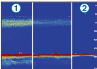
Sie können die Echodehnung auch zusammen mit der Filterbreite einsetzen, um eine bevorzugte Auflösung und Störungsreduzierung zu erzielen. Wenn Echodehnung und Filterbreite niedrig eingestellt sind, ist die Auflösung des Displays zwar am höchsten, allerdings ist es auch besonders störungsanfällig.
