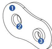
Si utilizas una placa de tuerca, el orificio más pequeño **3** de la placa de tuerca se debe alinear con el orificio más pequeño de la plantilla.
