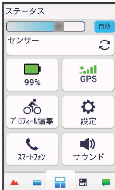
ステータスウィジェットが表示されます。ステータスウィジェットでは、各種センサーの接続状態が確認できます。センサー検索中は、各アイコンが点滅します。また、各オプション表示部を**タップ**すると、設定などの関連するメニューが表示されます。
