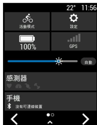
顯示設定小工具。閃爍的圖示代表裝置正在搜尋中。實心圖示代表裝置訊號已找到或感測器已連結。選擇圖示以變更設定。
